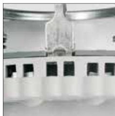
Vstupní svorky jsou v jedné rovině, vodiče zkrátíme na stejnou délku. Zásuvky mají již povolené svorky.
