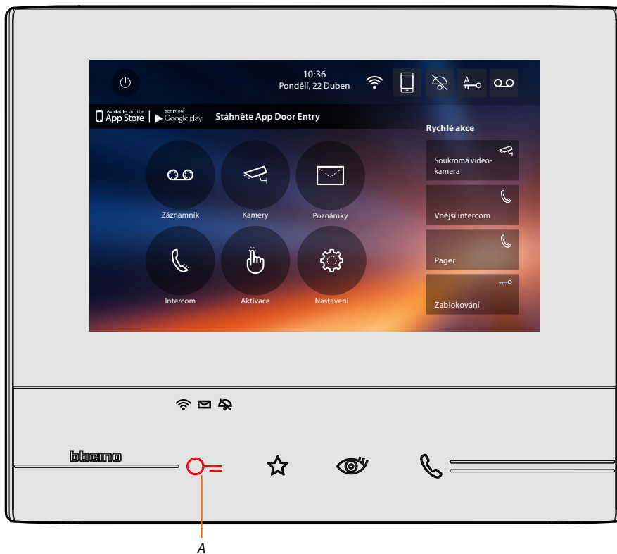
A. blikající LED = zámek otevřený.
